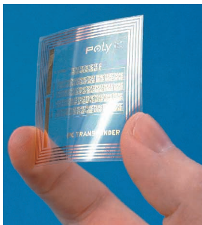
Anschauungsmuster einer der ersten polymeren flexiblen RFID-Tags aus dem Jahr 2006. (Bild: PolyIC GmbH)
