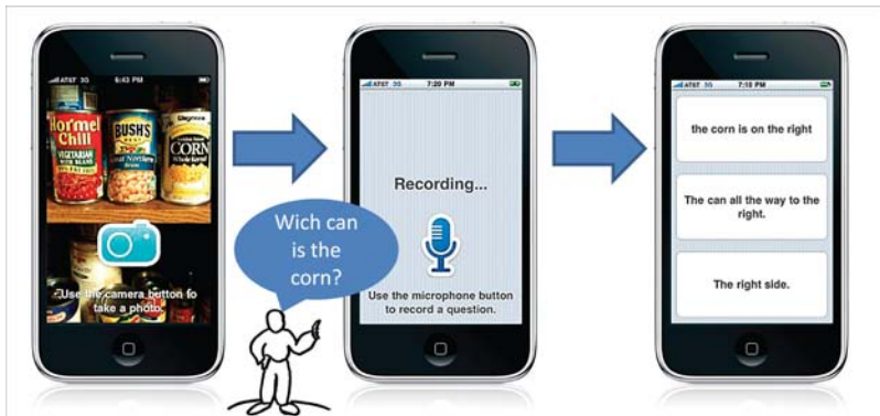
Abbildung 2: die VizWiz Smartphone App arbeitet in drei Schritten: ein Sehbehinderter macht ein Foto und nimmt eine Frage auf; beides wird an die Crowd gesandt, die die Antwort direkt zurück auf das Smartphone sendet;
